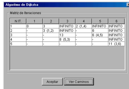
Figura 3. Iteraciones del algoritmo de Dijkstra
