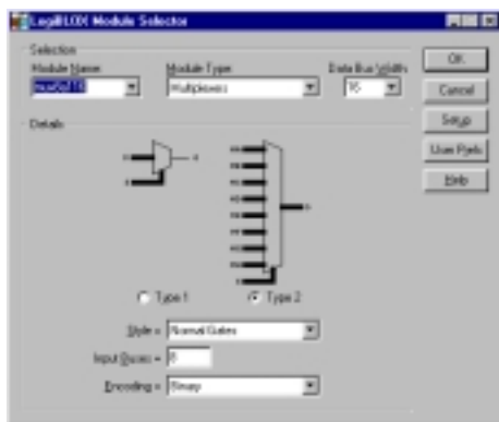
Figura 9. Creación de un multiplexor 8 a 1 de 16 bits
