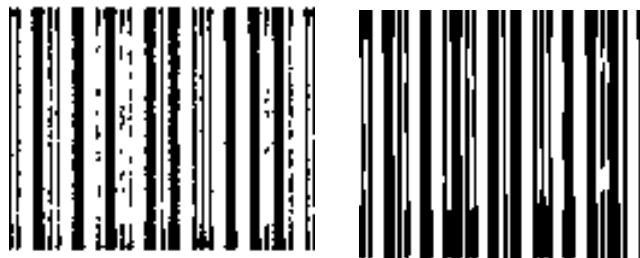
Figura 2. En la imagen de la izquierda, se muestra un código de barras degradado debido al uso de umbralización regional. En la imagen de la derecha, se muestra el resultado de la construcción del mismo código de barras usando una dilatación morfológica.
