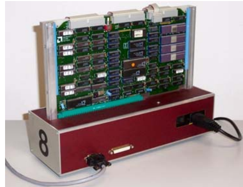
Figura 7. Tarjeta de evaluación Am29203 utilizada en prácticas de microprogramación.
