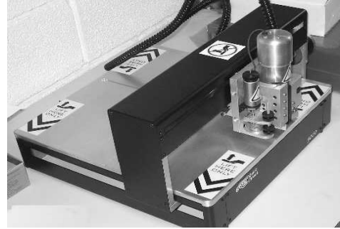
Figura 5. Diversos métodos de obtención de placas de circuito impreso: insoladora (izq.) y fresadora (der.). En el laboratorio se muestra a los alumnos brevemente ambos métodos
