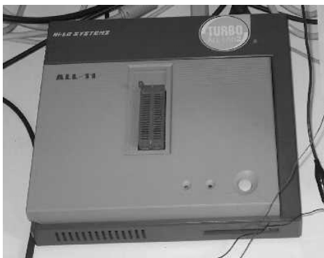
Figura 6. Programador ALL-11 para el microcontrolador.
