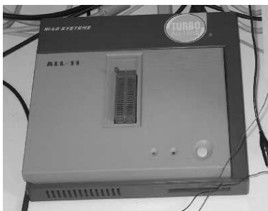
Figura 6. Programador ALL-11 para el microcontrolador.
