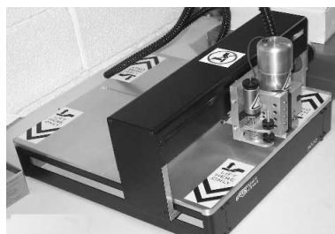
Figura 5. Diversos métodos de obtención de placas de circuito impreso: insoladora (izq.) y fresadora (der.). En el laboratorio se muestra a los alumnos brevemente ambos métodos
